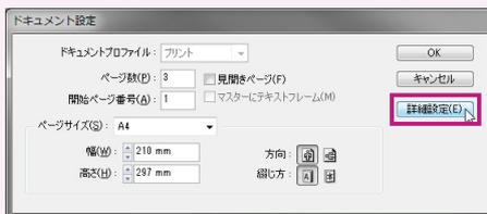
ドキュメント設定ダイアログボックスの「**詳細設定**」をクリックすると、「**裁ち落としと印刷可能領域**」が表示されます。
