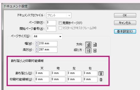
「**印刷可能領域**」とは、ページの外側に配置する情報（サイズ・色・説明などの補足的情報）を印刷できる領域を設定します。印刷可能領域は、最終的にページサイズで裁断される際に削除（切り落とされる）されます。
